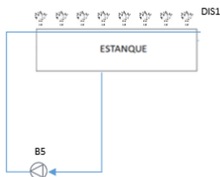
Figura 54. Esquema disipación estanque anfiteatro
