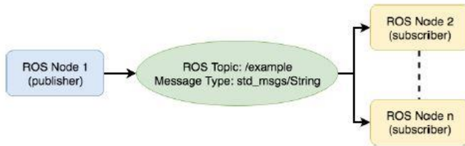
Figura 2. Configuración de ROS con nodos publicadores y suscritos compartiendo datos mediante tópicos. [11]
