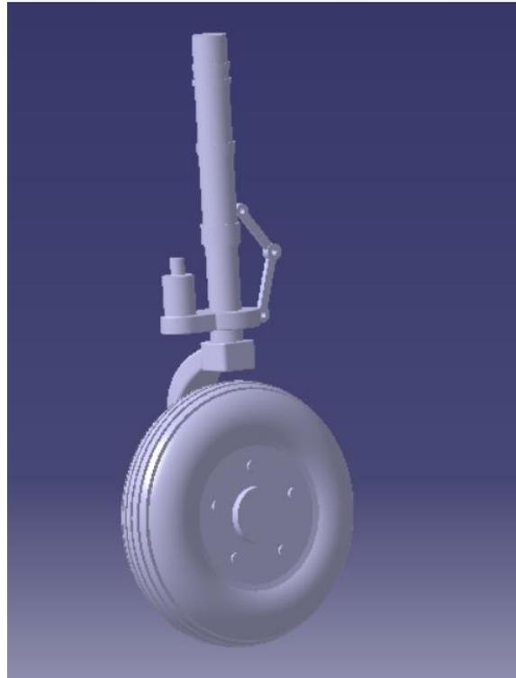
Figura 103. Modelado del tren de proa.
