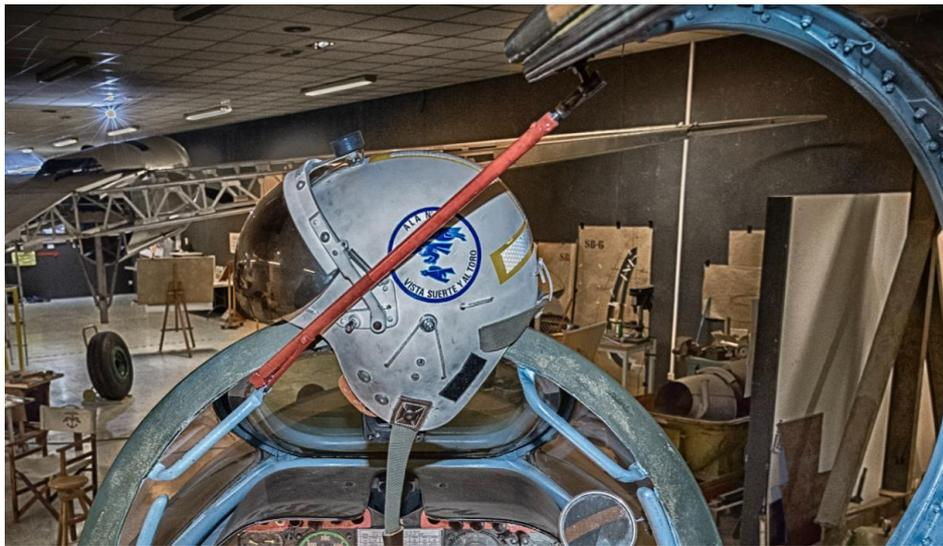
Figura 123. Barra que sujeta la puerta de la cabina.
