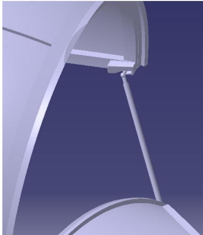
Figura 129. Barra en posición de apertura de la cabina.
