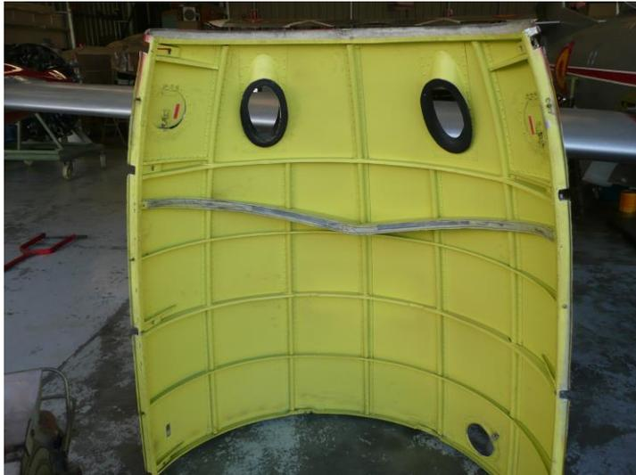
Figura 56. Capó del motor
