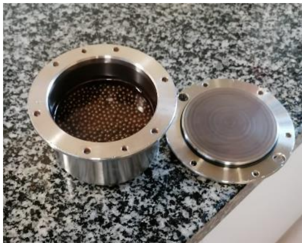
Figura 3.5 - Vasija con agua destilada y polvo
