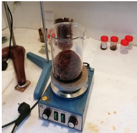
Figura 3.2 - Montaje empleado para realizar la síntesis del polvo de hematita (una vez formado el gel).
