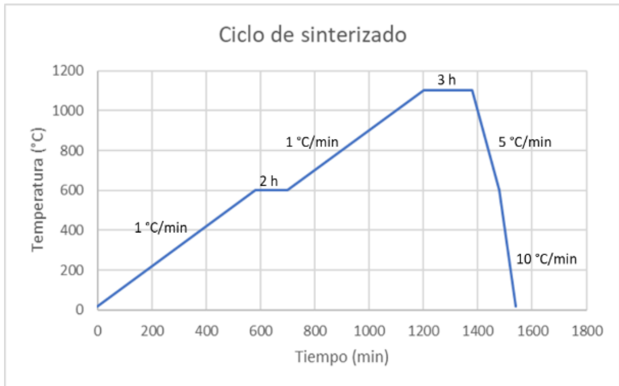
Figura 3.9 - Ciclo de sinterizado
