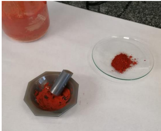
Figura 3.7 - Triturado de polvo en mortero de ágata.
