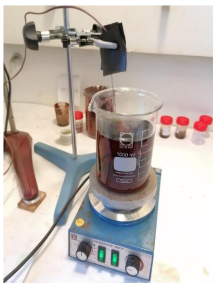
Figura 3.1 - Montaje empleado para realizar la síntesis del polvo de hematita (antes de la formación del gel).
