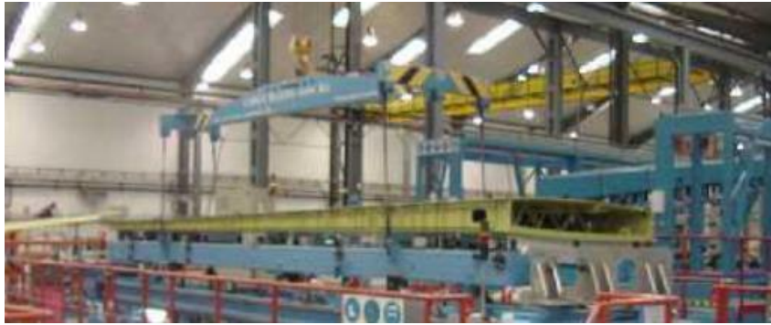
Figura 4-67. Foto del posicionamiento del cajón alar en la Estación Horizontal [3]
