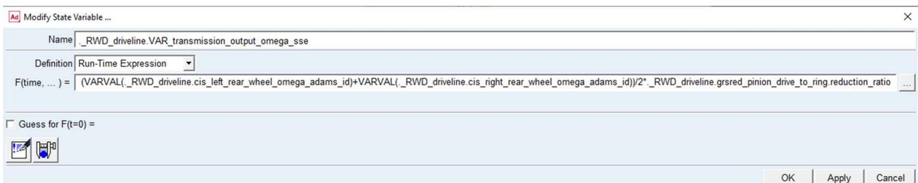
Ilustración 14: Definición de la variable de estado **VAR\_tranmission\_output\_omega\_sse**.
