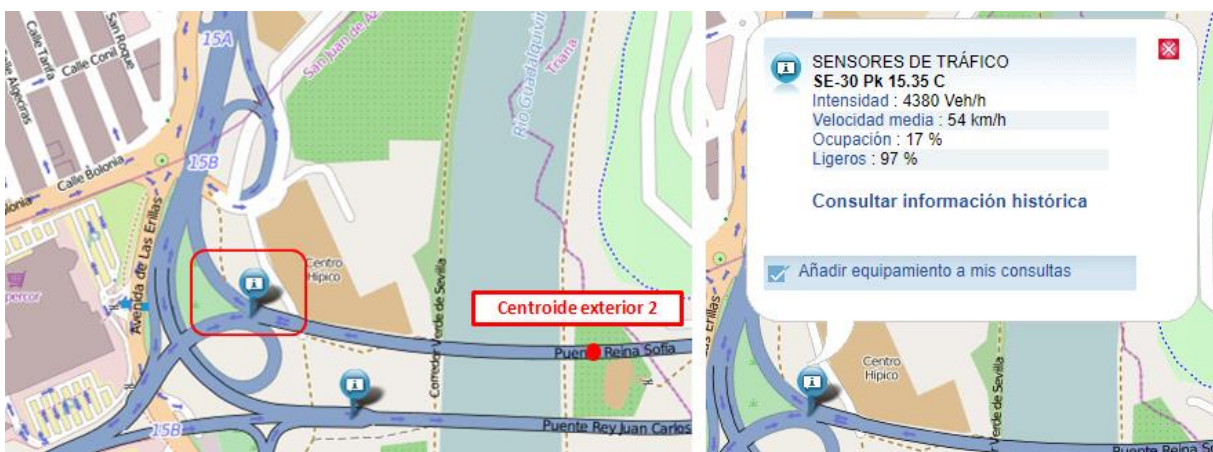
Ilustración 3-19: Datos del sensor de tráfico situado cerca del Centroide exterior 1. Fuente: Web Infocar (DGT).
