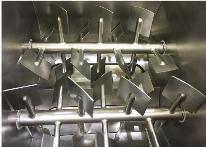
**Figura 1.2** Mezcladora de palas WZ Series, SBL.
