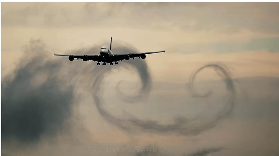
**Figura 1.1** Vórtices de punta de ala tras un A380 aterrizando en el aeropuerto de Zurich.
