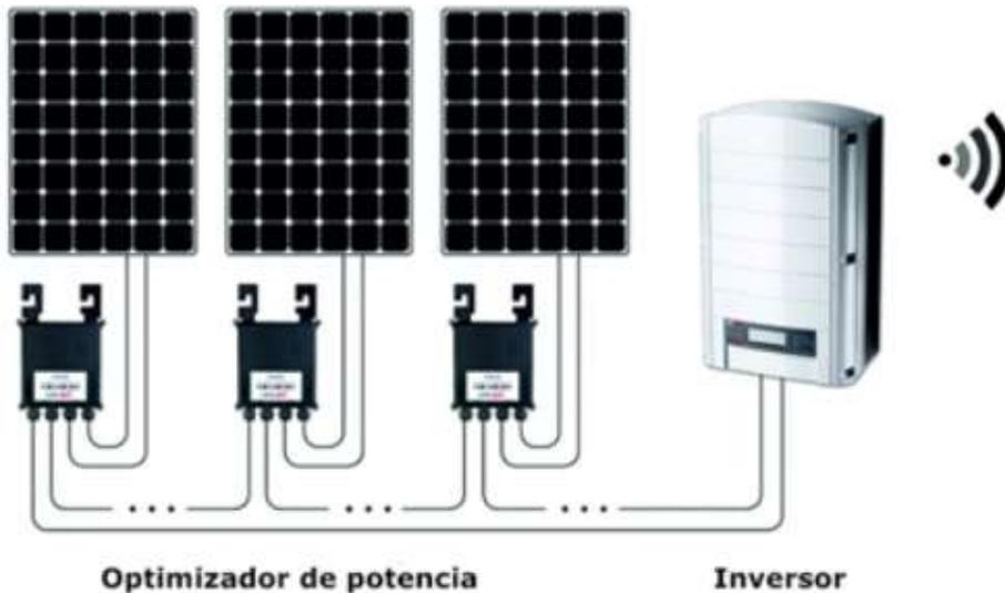
Figura 10. Optimizador de potencia
