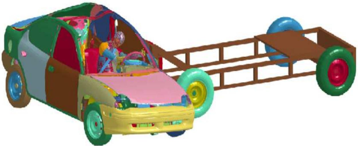
Figura 1-3. Simulación por Elementos Finitos de un choque lateral de un coche [4]
