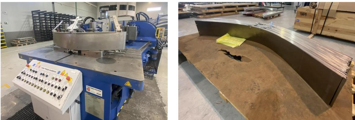
Figura 3-1. Molde instalado en la máquina Erie y piezas tras el estirado, instalaciones M&M.
