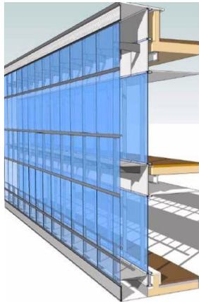
Figura 5. Esquema de muro cortina. Muro no estructural.[3]
