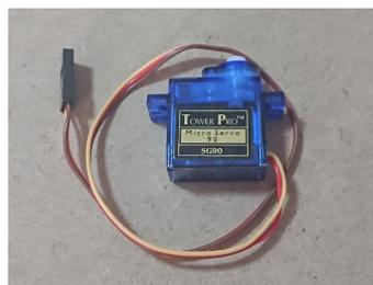
**Figura 3.2** Servomotor SG90.
