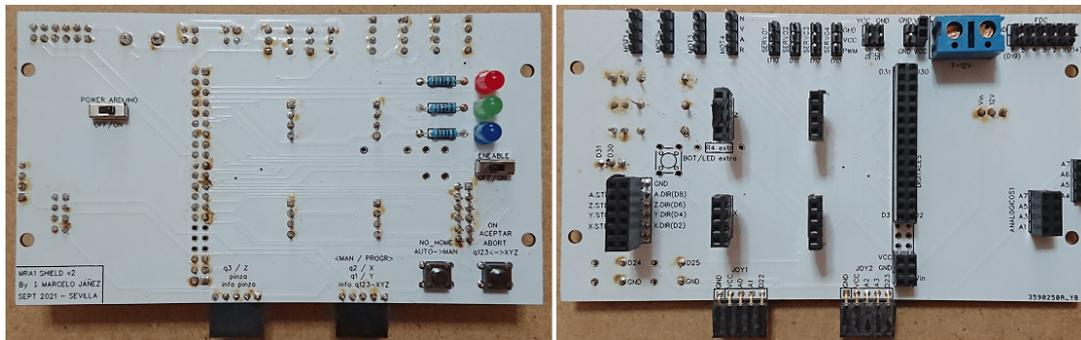
Figura 7.5 PCB con los componentes soldados.
