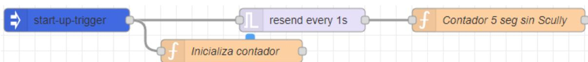
Ilustración 4-14. Configuración del contador para la variable *Scully*.
