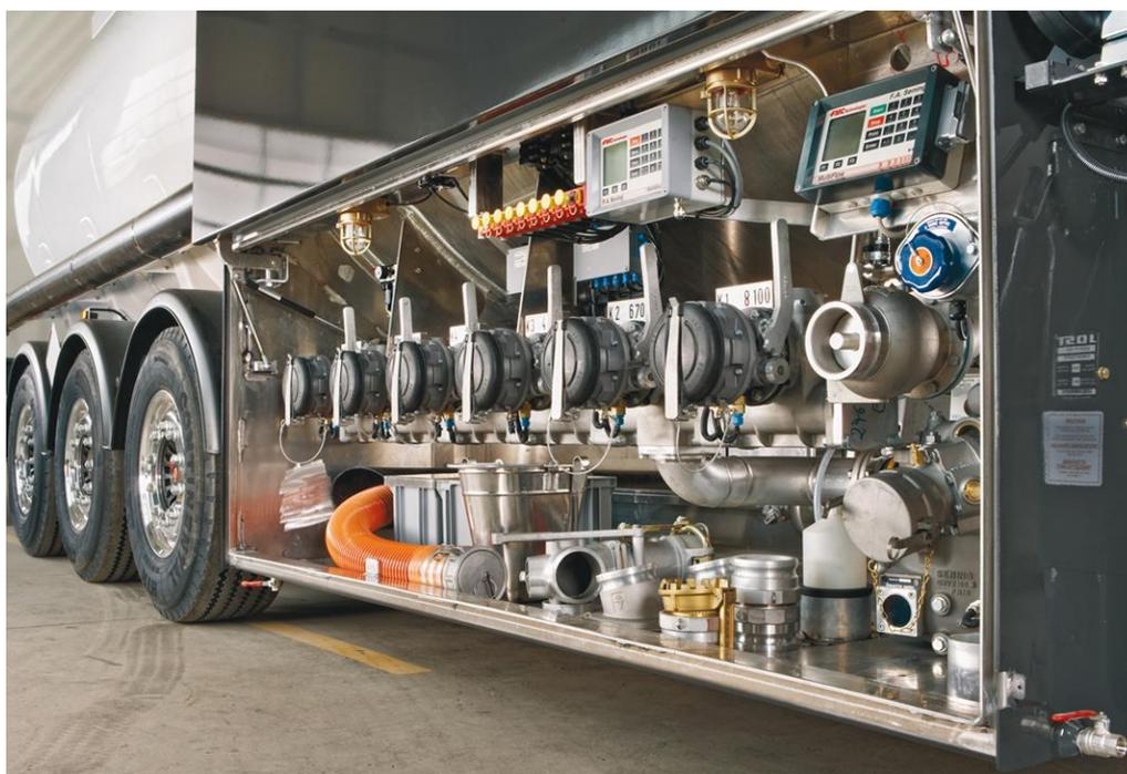
Ilustración 3-1. Sistema de sellado instalado en un camión cisterna [13].
