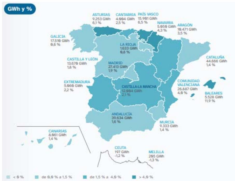
Ilustración 31. Ratio generación/demanda (%) y generación (GWh) en 2021 por CCAA
