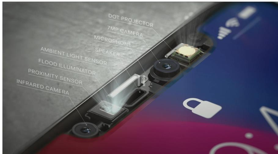
**Figura 7.2** Componentes del Face ID. (Perekalin, 2017).
