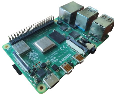
**Figura 4.3** Raspberry Pi 4 Modelo B. Elaboración propia.
