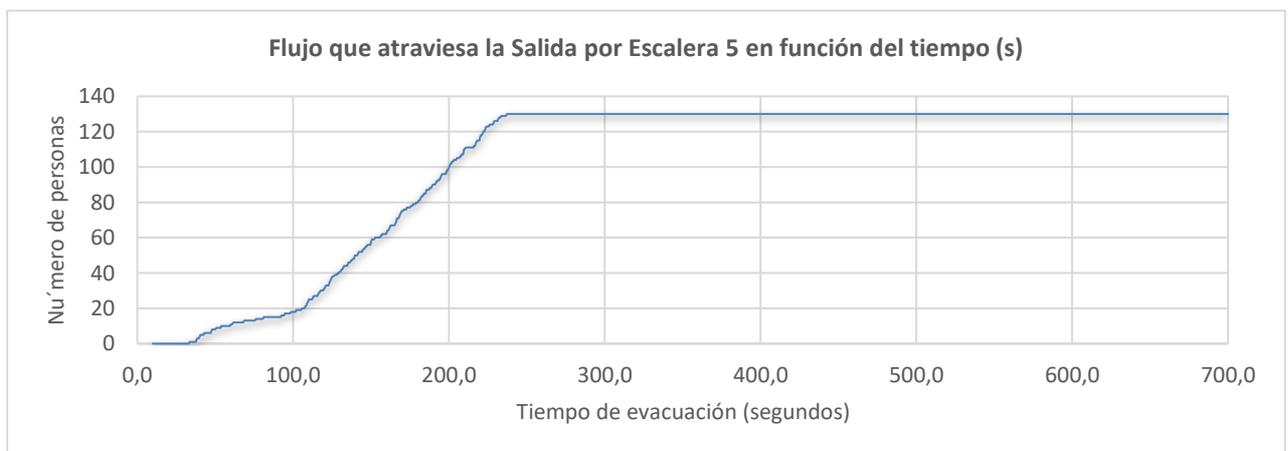
Figura 88. Flujo que atraviesa la Salida por Escalera 5 (Planta dos)
