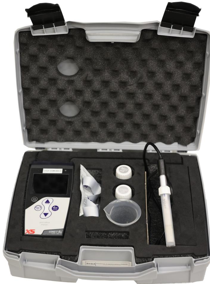
Figura 3.9: Maletín con los elementos del conductímetro-pHímetro
