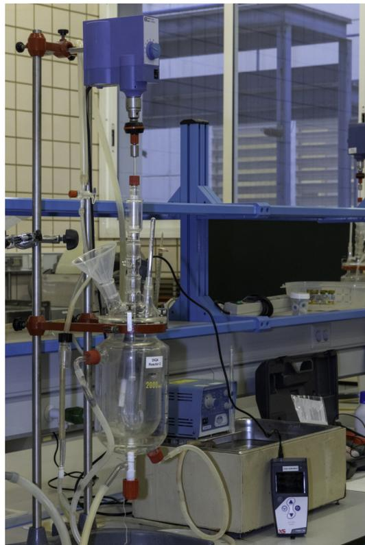
Figura 3.2: Reactor usado para los ensayos
