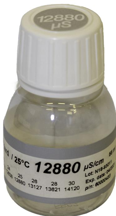
Figura 4.2: Uno de los patrones de calibración utilizados
