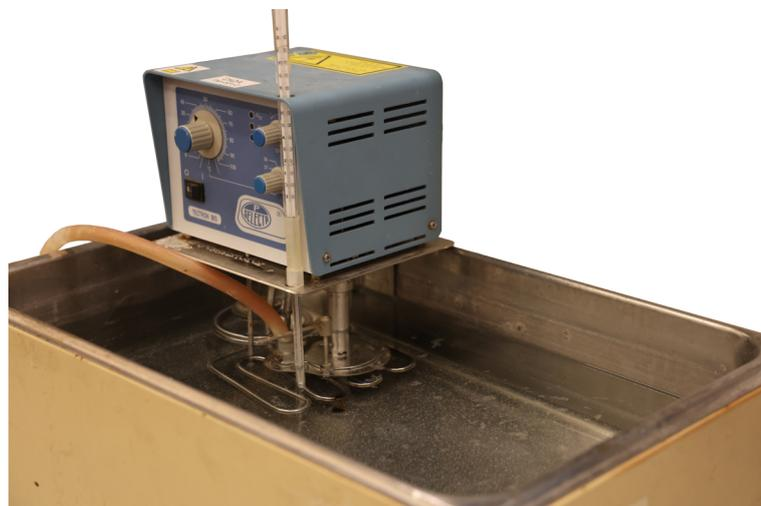
Figura 3.6: Baño termostático empleado
