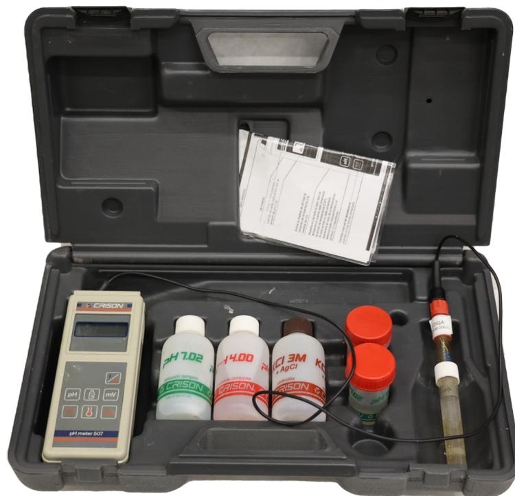
Figura 3.8: Maletín con los elementos del pHímetro
