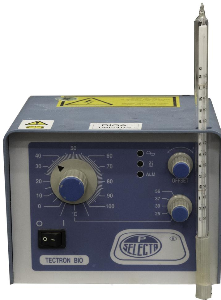
Figura 3.5: Regulador de temperatura del baño
