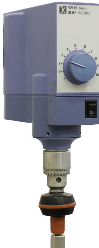
Figura 3.3: Regulador de velocidad del agitador
