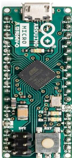
Figura 2.31. Placa Arduino Micro.
