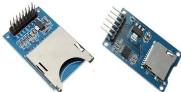
**Figura 2.35.** Módulos tarjeta SD y Micro SD.
