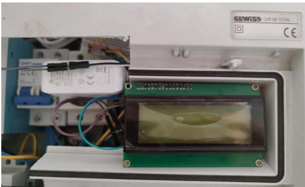
**Figura 4.15.** Pantalla LCD instalada en puerta de cuadro eléctrico.
