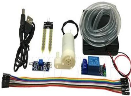
Figura 2.39. Kit básico de riego automático.
