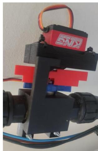
**Figura 4.6.** Servoválvula con motor MG996R.
