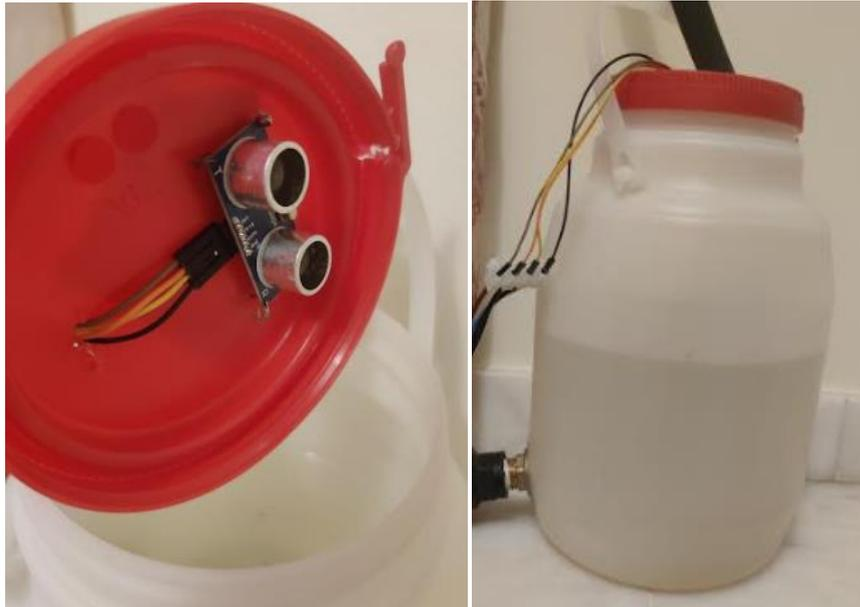
Figura 5.4. Ensayo con sensor de ultrasonidos y depósito 5 litros.
