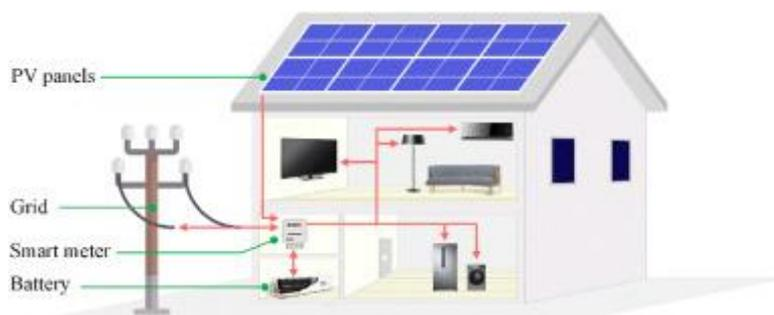
Ilustración 12. Esquema del sistema FV y batería como apoyo al hogar tipo.
