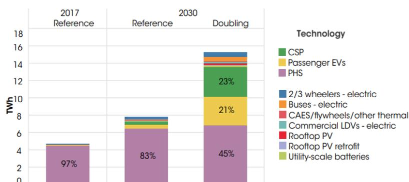
Ilustración 1. Crecimiento del almacenamiento eléctrico por aplicación. Disminución del uso del bombeo (PHS) en los escenarios previstos: Referencia (conservador en el incremento de las energías renovables) y Doble (duplicación de las renovables).
