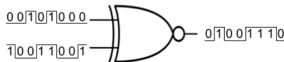
Figura 1.8 Multiplicador de números estocásticos bipolares construido con una puerta XNOR. El resultado obtenido a la salida es P(X_o = 1) = P(X_a = 1) \cdot P(X_b = 1) .
