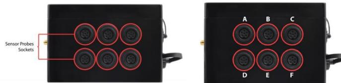
**Figura 11.** Terminales de conexión del Smart Water
