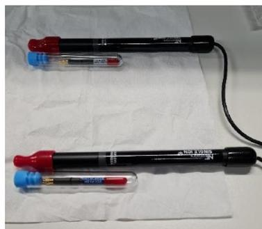
**Figura 83.** Sensor y referencia junto a sus respectivos retenedores
