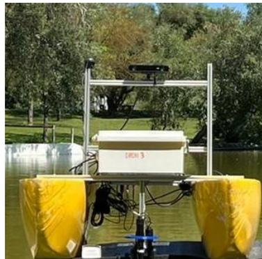
*Figura 17. Vista frontal del ASV y posición de los sensores*
