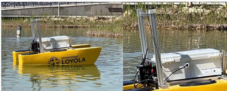
*Figura 44. Detalle de la conexión del Smart Water con el ASV*
