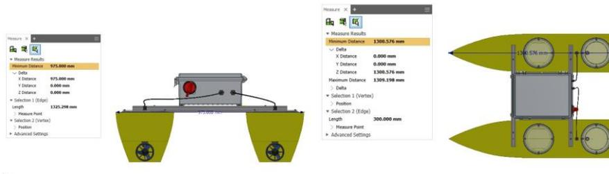
**Figura 4.** Vista de alzado y planta del ASV del proyecto junto a sus dimensiones
