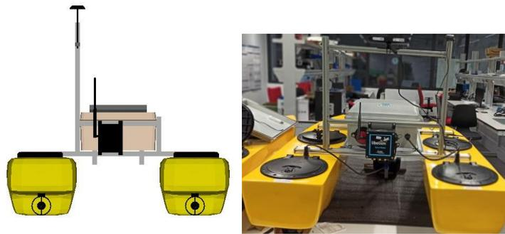
*Figura 16. Posición estimada y final del Smart Water en el ASV*
