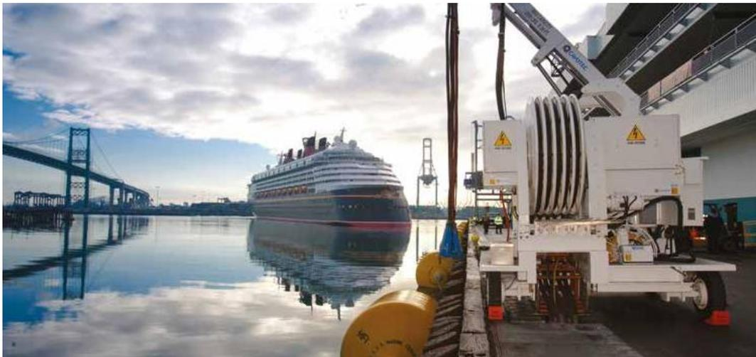
Imagen 39. Sistema de conexión para buques Con/Ro. [15]
