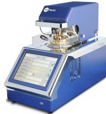
Figura 2.4.- Analizador automático de punto de inflamación de Pensky-Martens (27)
