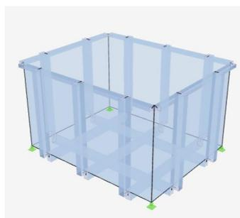
Figura 3.3.- Refuerzos en las esquinas tanques rectangulares (41)
