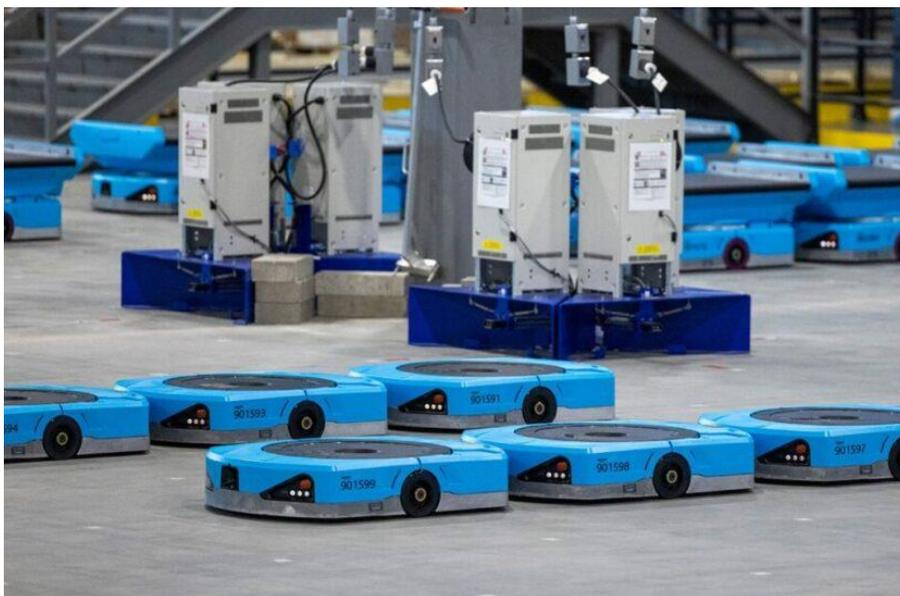
Figura 13 - Sistema robótico Hércules, Amazon. Fuente:[21]
