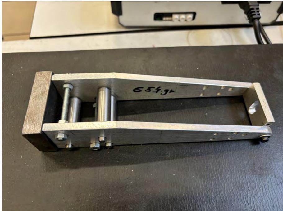
**Figura 4.11** Primera versión del carrito de pelado del ensayo HOD.
