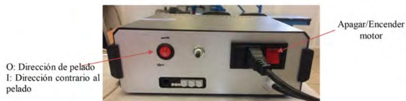
Figura 4.28 Funcionamiento de la caja de control asociada al motor de pelado [20].
