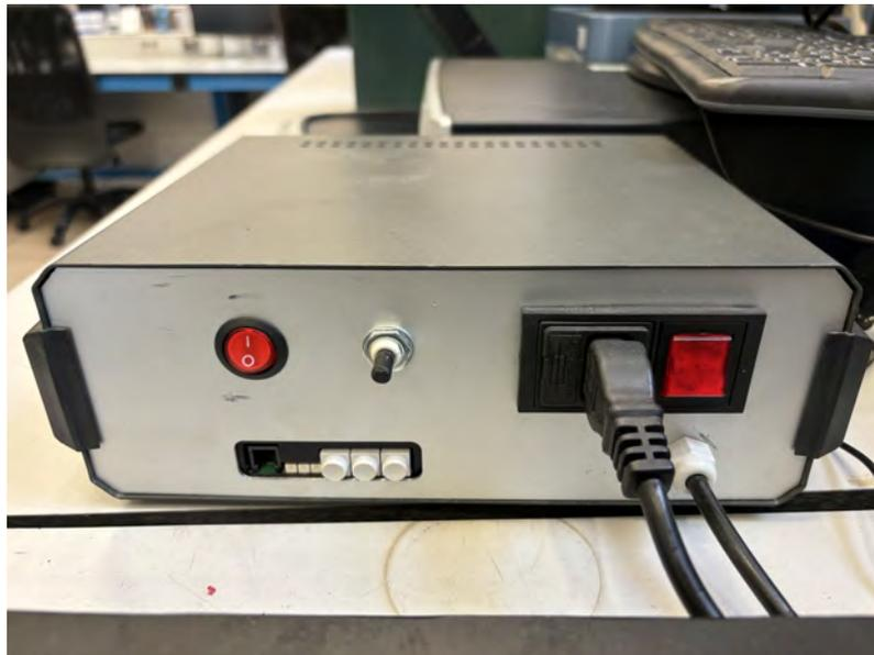
**Figura 4.7** Caja de control del ensayo HOD.
