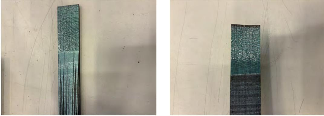
**Figura 1.5** Modos de fallo identificados durante la realización de los ensayos del presente caso de estudio.
