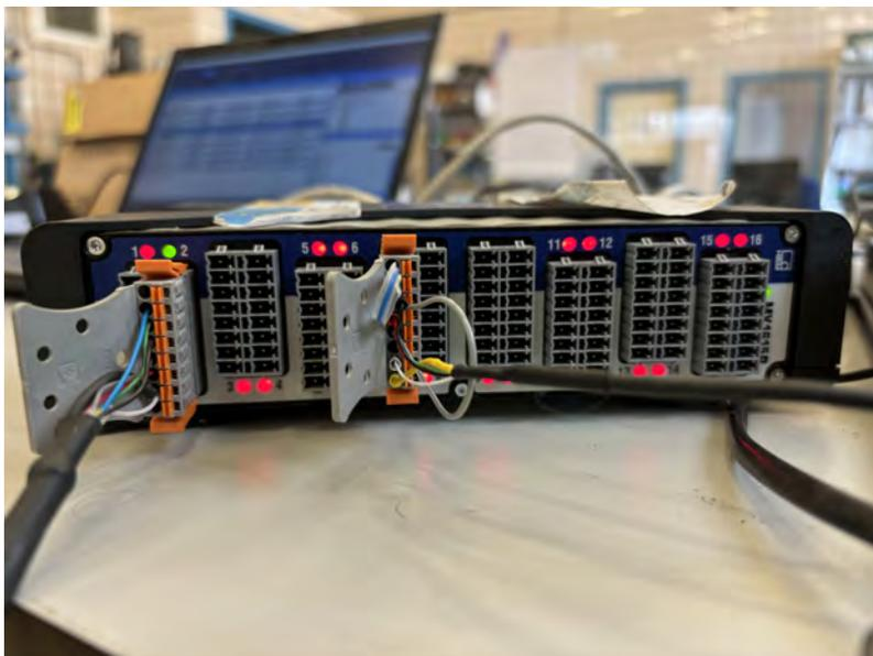
Figura 4.14 Conexión de puertos en el módulo de adquisición de datos *Quantum HBM MX1615B*.
