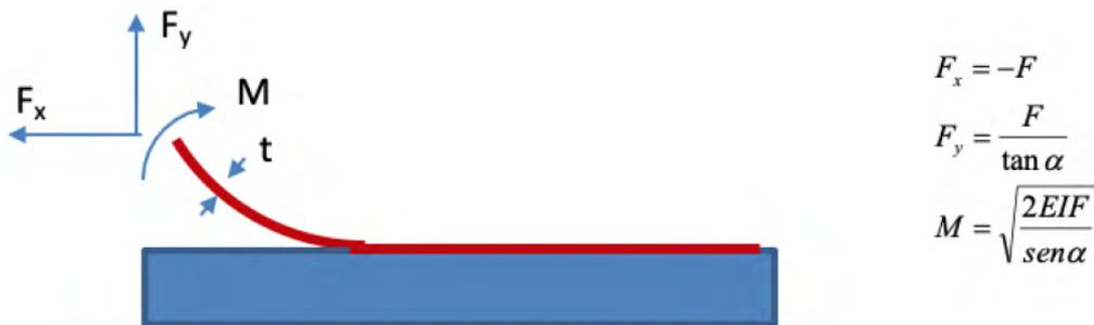
Figura 3.5 Esfuerzos en el vértice de la grieta [20].
