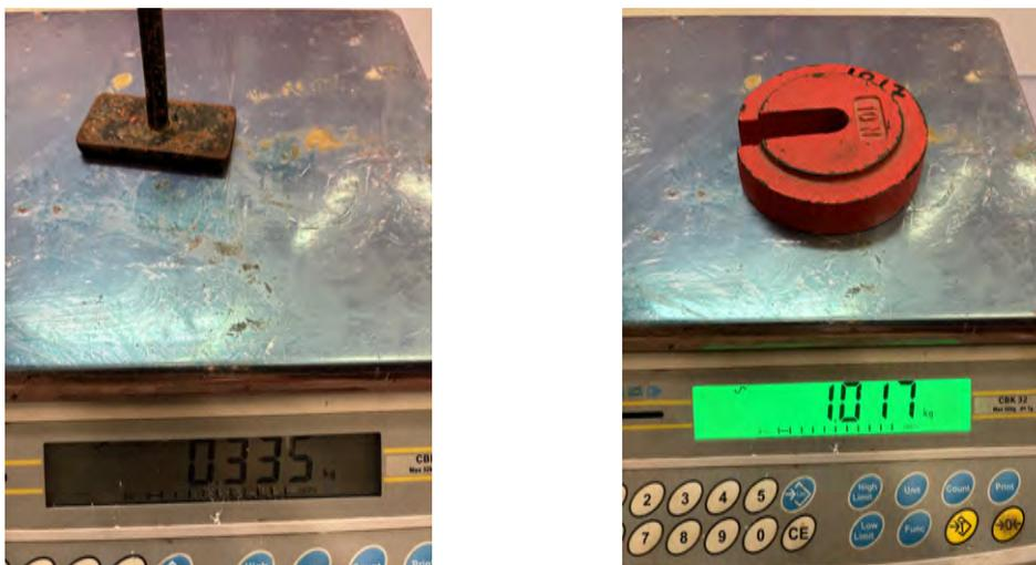
**Figura 4.19** Pesos utilizados para la calibración manual de la célula de carga DYMH-103 de 20 kg.
