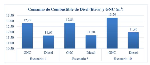
Figura 30. Comparativo de consumos de combustible de Diesel (litros) y GNC (m³)
