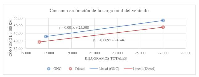
Figura 27. Consumo en función de la carga total del vehículo
