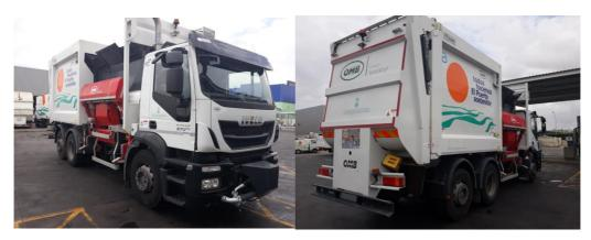
Figura 25. Vehículo GNC de recogida carga lateral
