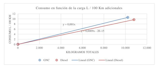
Figura 28. Consumo en función de la carga en litros por cada 100 kilómetros adiciones
