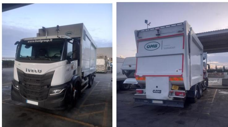
Figura 26. Vehículo diésel de recogida carga lateral
