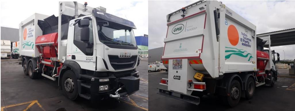
Figura 25. Vehículo GNC de recogida carga lateral
