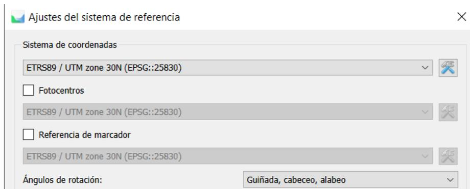
Figura 3-6: Elección del sistema de referencia deseado en Metashape®.
