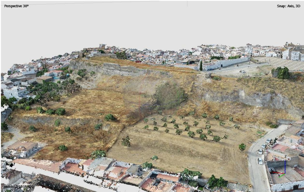
Figura 4-8: Nube de puntos densa generada en la Zona 1 en Metashape®.
