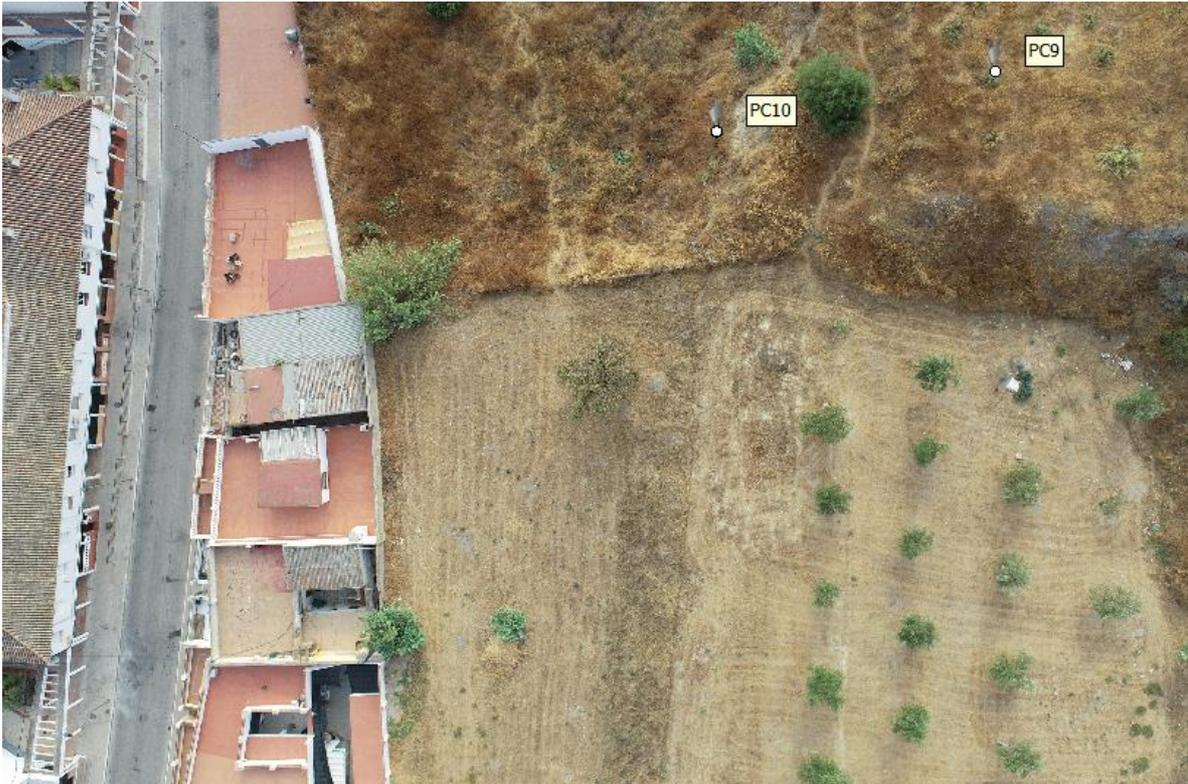
Figura 4-4: Primera aproximación de PC9 y PC10 realizada por Metashape® al cargar las coordenadas de los PC.
