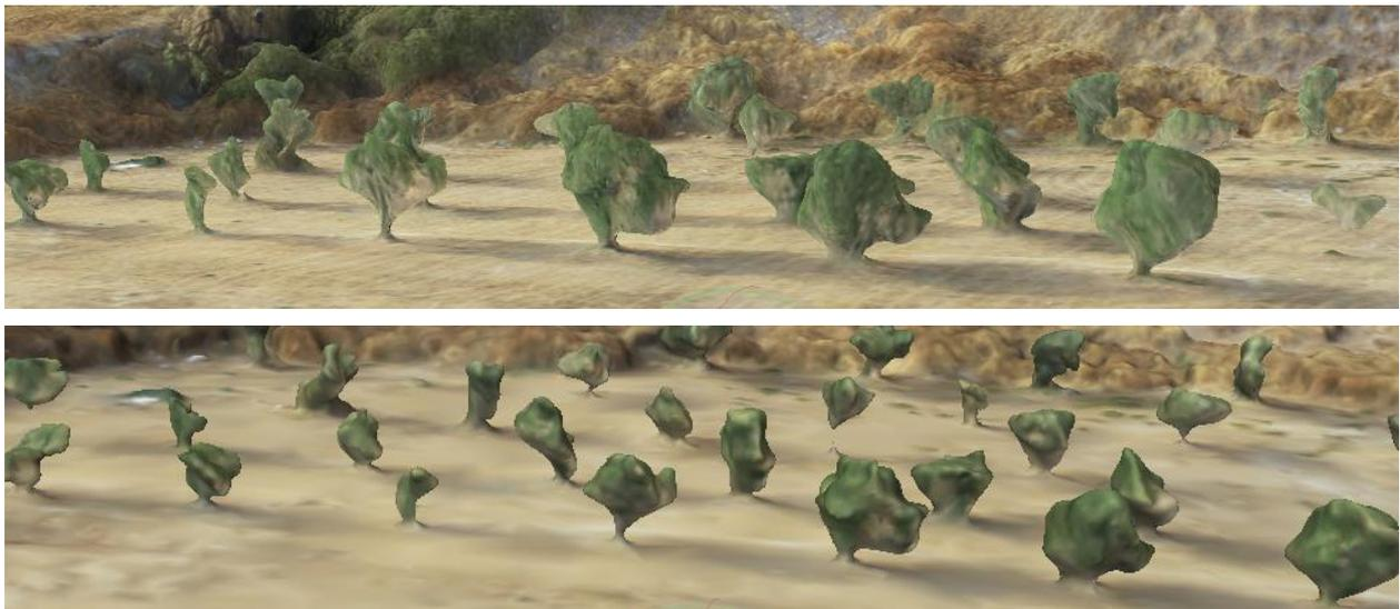
Figura 4-14: Comparativa de representación de vegetación alta en modelo texturizado (arriba) con respecto a modelo mallado (abajo) generados en Metashape®.
