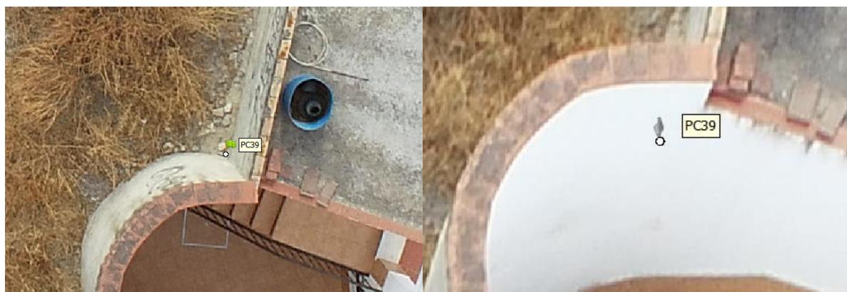
Figura 4-6: Proyección de PC válida (izquierda) en comparación proyección no válida del mismo PC por falta de visibilidad (derecha). Metashape®.
