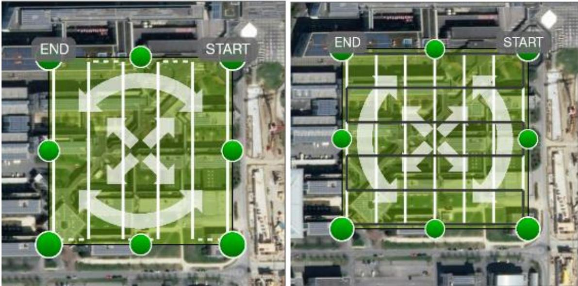
Figura 2-8: Ejemplo de planificación de vuelo en rejilla simple (izquierda) y doble (derecha) en Pix4DCapture [34].
