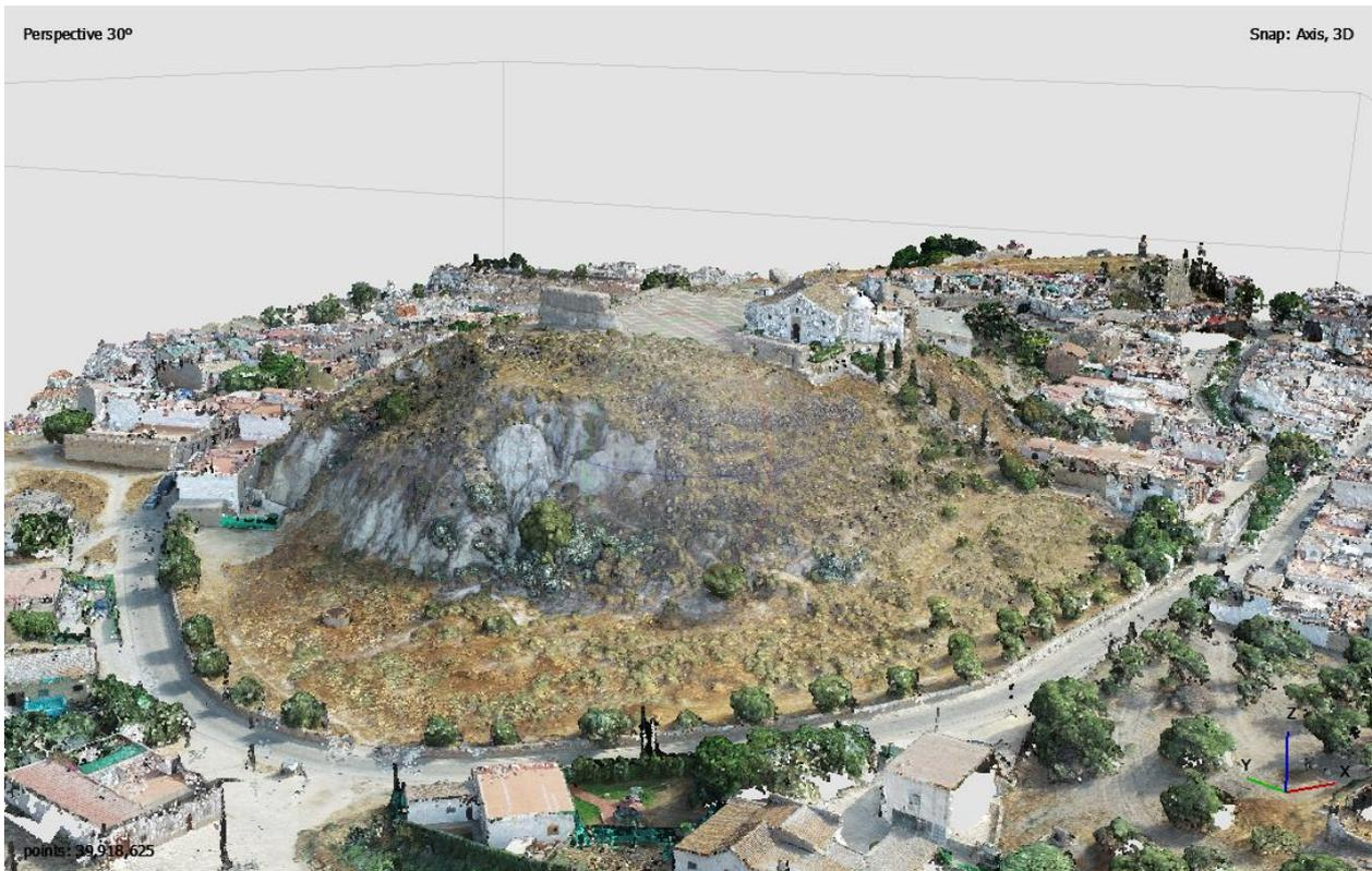
Figura 4-9: Nube de puntos densa generada en la Zona 2 en Metashape®.
