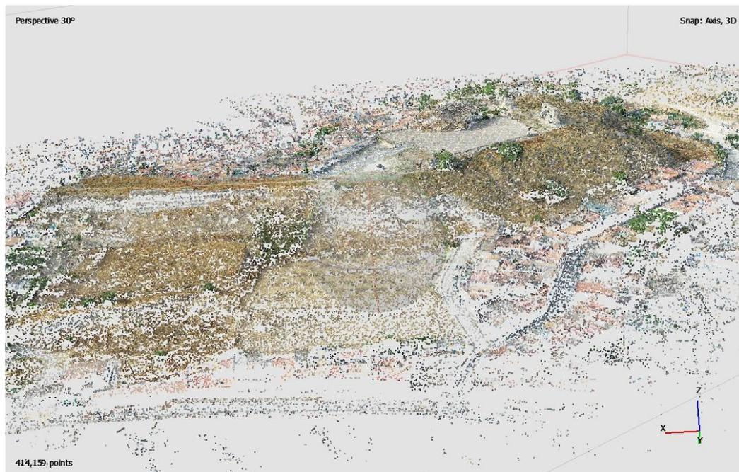
Figura 4-2: Nube de puntos dispersa generada en la Zona 1 de estudio en Metashape®.
