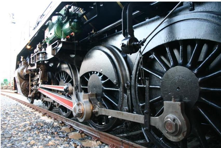
Figura 2-19 Biela, manivelas y ruedas motrices, [31]
