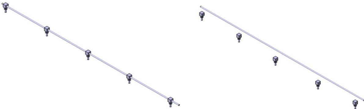
Figura 4-74 L1-68: BOILER HAND RAIL y a la izquierda aplicando la función *Explode*
