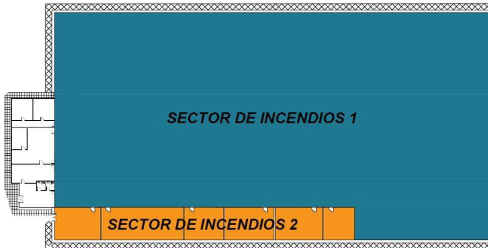
*Ilustración 38. Diferentes sectores de incendios en la planta*
