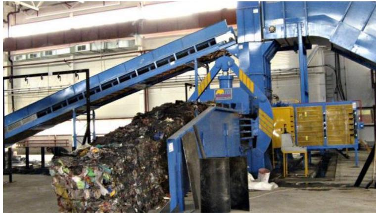
*Ilustración 12. Compactadora de recortes*
