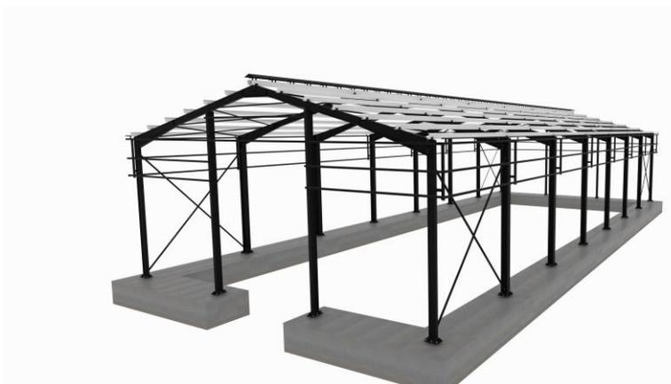
*Ilustración 22. Ejemplo de disposición de pórticos con apoyo intermedio*
