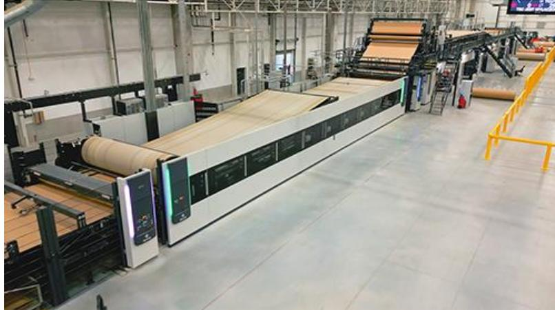
*Ilustración 7. Onduladora tipo BHS modul facer MF-A*
