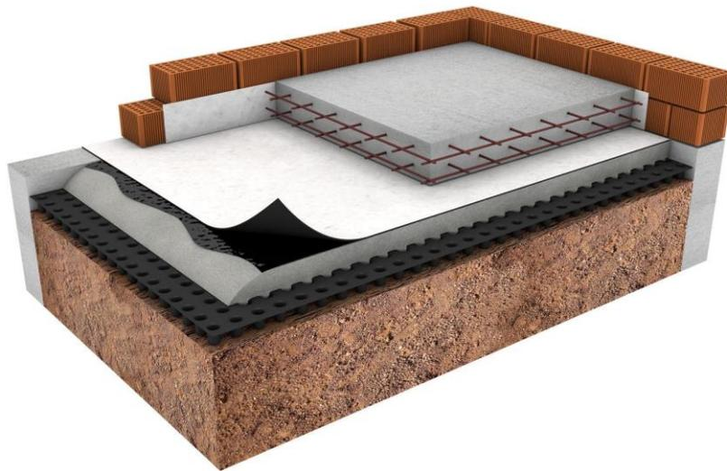
*Ilustración 29. Detalle constructivo de la solera*
