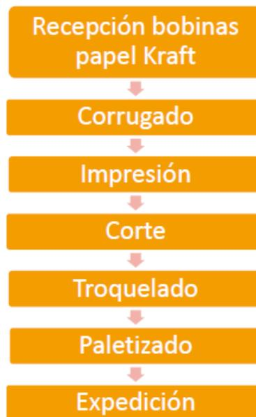
*Ilustración 1. Proceso de fabricación del cartón ondulado*
