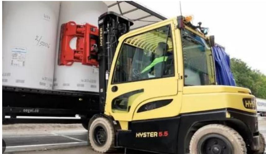
*Ilustración 20. Carretilla transportadora de bobinas de papel Kraft*
