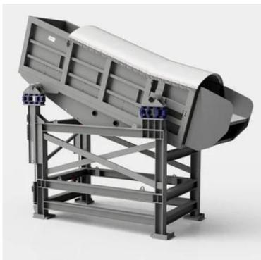
Ilustración 38: Criba vibratoria (97)
