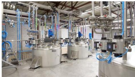
Ilustración 35: Reactores de tanque agitado (94)
