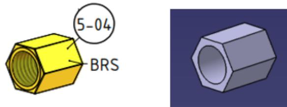
Figura 125. Esquema [1] y modelado de la *saddle tank stop nut* en CATIA V5
