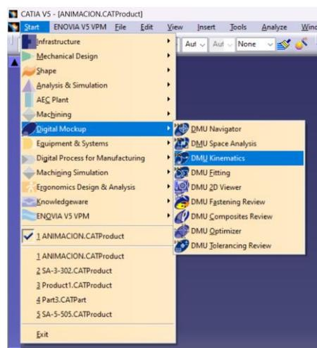
Figura 185. Acceso al módulo *DMU Kinematics*
