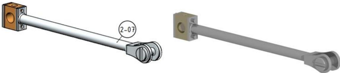
Figura 164. Esquema [1] e imagen renderizada del conjunto SA-2-203
