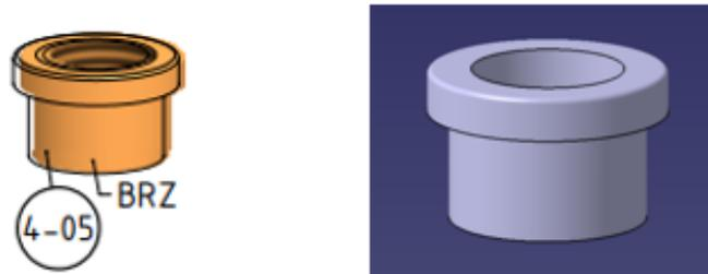
Figura 98. Esquema [1] y modelado de la *Boiler Bush-Type-2* en CATIA V5
