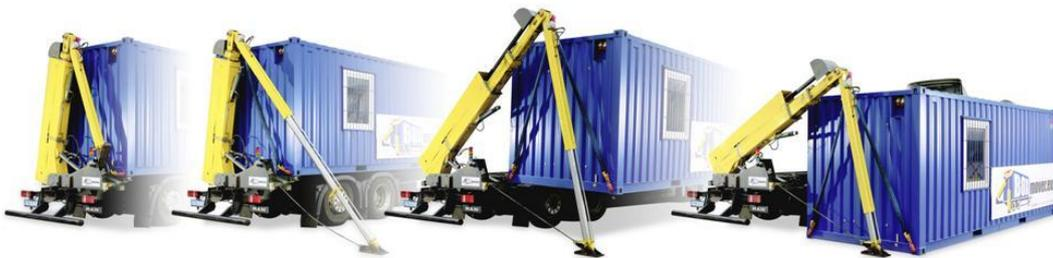
Fig. 11. Proceso de desplazamiento del Side Leader Truck
