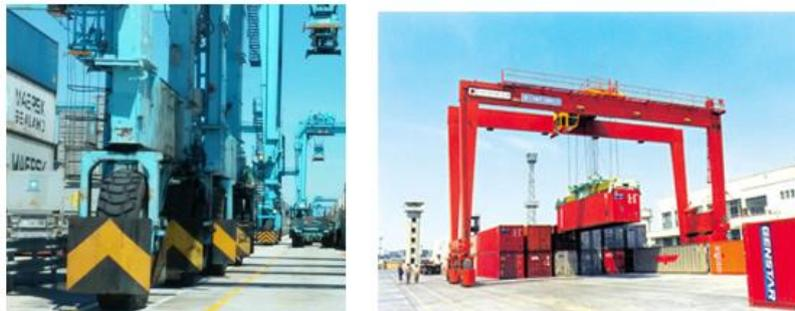
Fig. 7. Grúa pórtico sobre neumáticos
