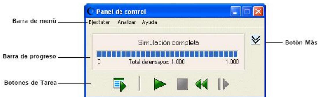
Figura 1.10 El Panel de Control de Crystal Ball
