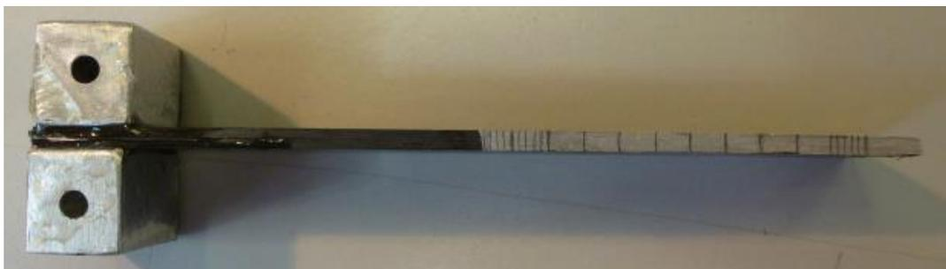
Figura 34 – Probeta ISO 15024
