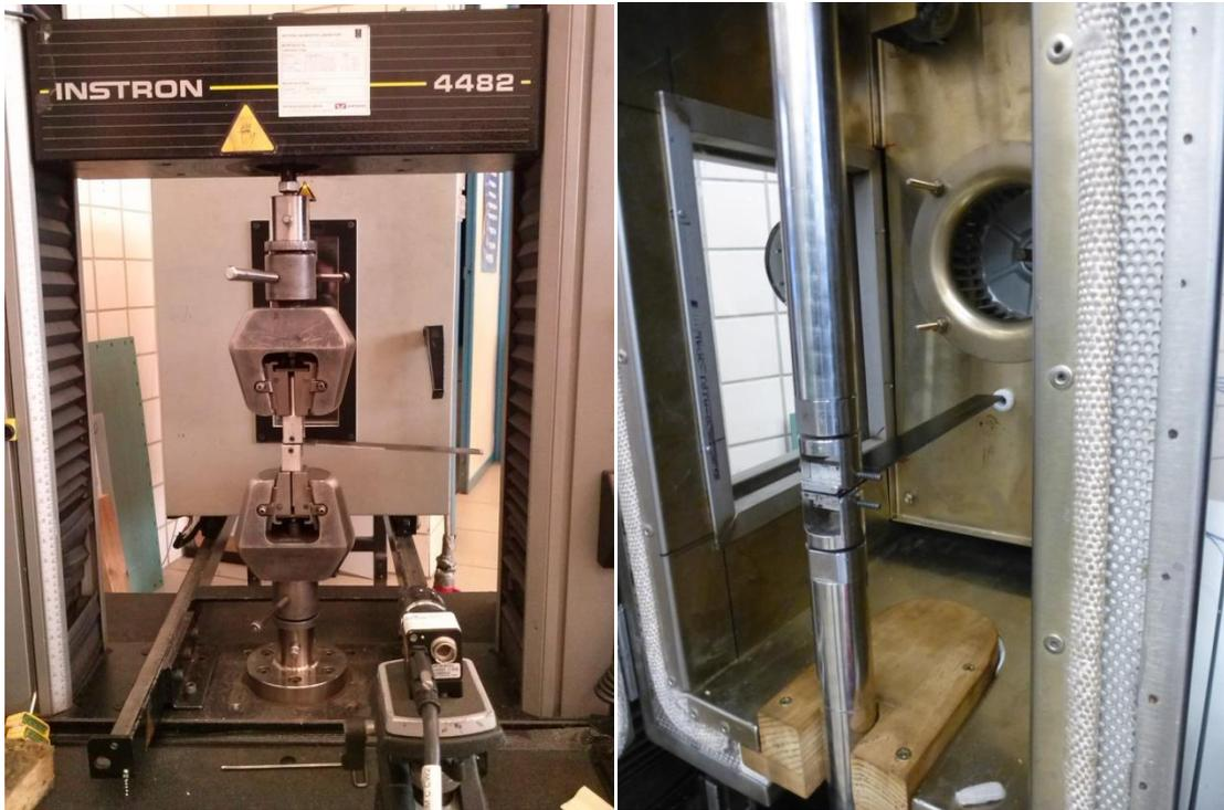
Figura 24 - Montajes Finales: Dentro y fuera de la Cámara Climática
