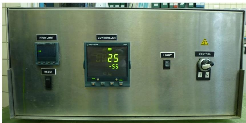
Figura 26 - Controlador Temperatura de la Cámara Climática
