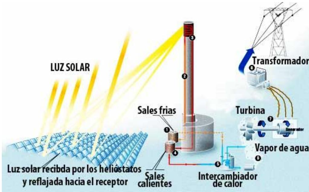
Habitualmente se usan concentradores solares por reflexión para alcanzar las temperaturas requeridas en la operación de los ciclos termodinámicos. Los tres conceptos de concentración solar más utilizados son:
