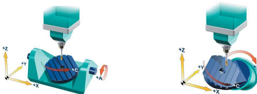
Ilustración 7. Máquina herramienta de 5 ejes con 2 ejes giratorios en la mesa.
