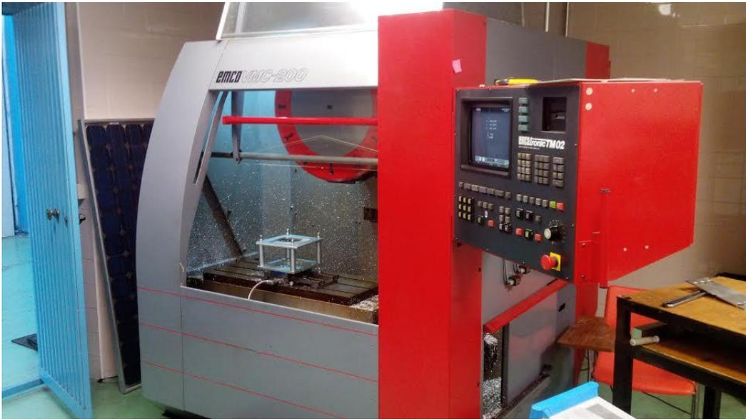
*Figura 3.3- Centro de mecanizado vertical EMCOTRONIC TM02 VMC200*
