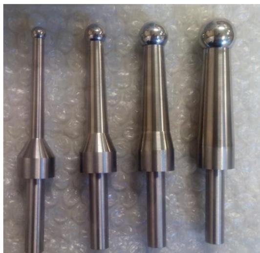
*Figura 3.2- Herramientas usadas en los ensayos de SPIF de 8 a 20 mm de diámetro*
