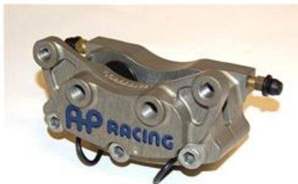
Figura 49 Pinza delantera
