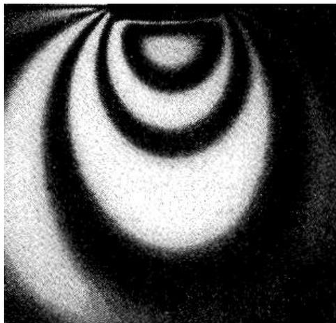
**Figura 4-1.** Distribución de tensiones en un contacto normal [9]
