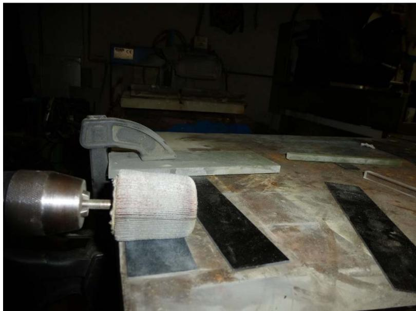
Fig. II.1.18. *Lijado del laminado de CFRP (Elaboración propia).*
