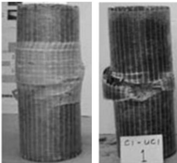
Fig. I.6.7. *Probetas cilíndricas reforzadas con material compuesto sometidas a ensayos de compresión (Fuente: [15]).*
