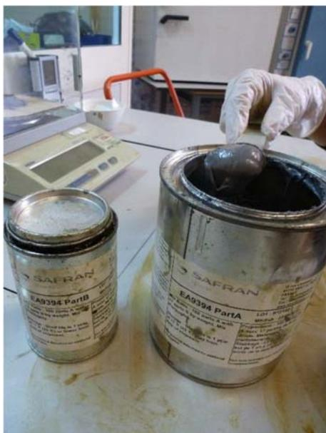
Fig. II.1.23. Adhesivo aeronáutico de dos componentes, EA-9394 (Elaboración propia).
