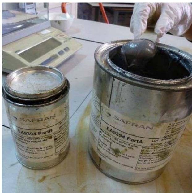
Fig. II.2.7. Adhesivo aeronáutico de dos componentes, EA-9394 (Elaboración propia).
