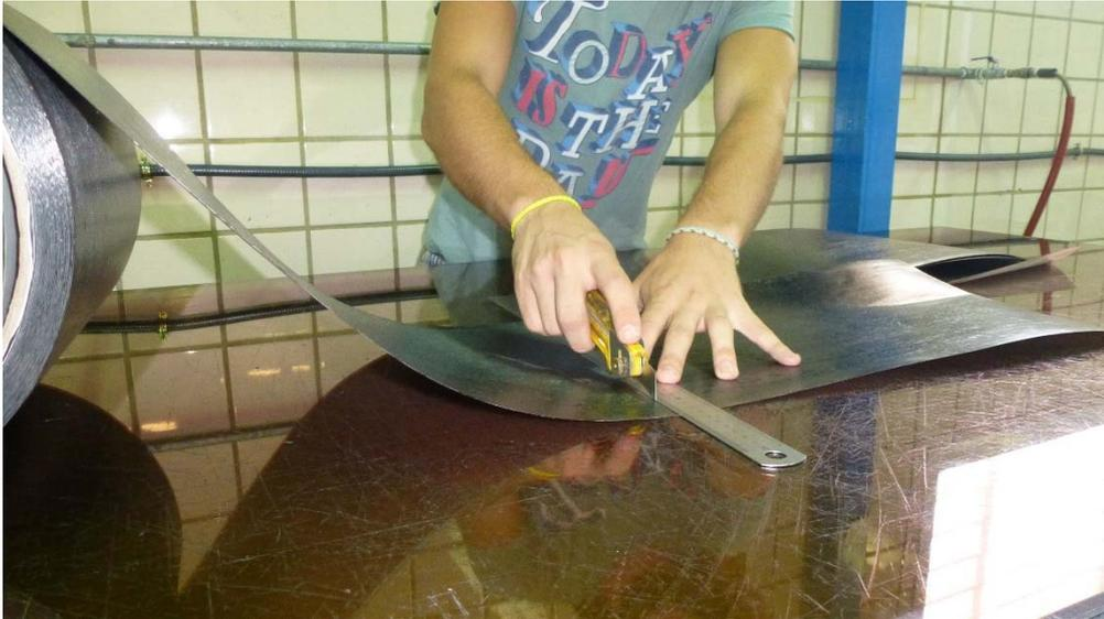
*Fig. II.1.3. Corte de la lámina a 400cm de longitud. (Elaboración propia).*
