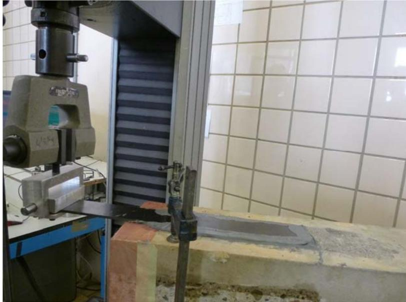
Fig. II.1.32. *Disposición del ensayo con la carga en el extremo (Elaboración propia).*
