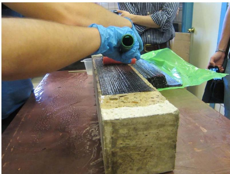
Fig. II.2.3. *Pegado de la lámina de CFRP al hormigón (Elaboración propia).*
