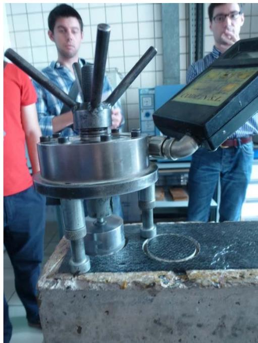
Fig. II.2.12. *Máquina de ensayo de Pull Off (Elaboración propia).*
