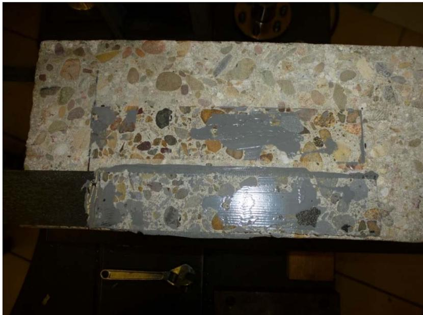
Fig. II.1.40. Vista de la rotura del ensayo LP-200 II (Elaboración propia).
