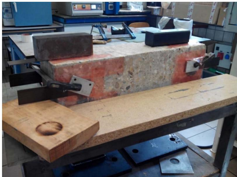
Fig. II.1.25. Aplicación de presión mediante gatos y pesas (*Elaboración propia*).
