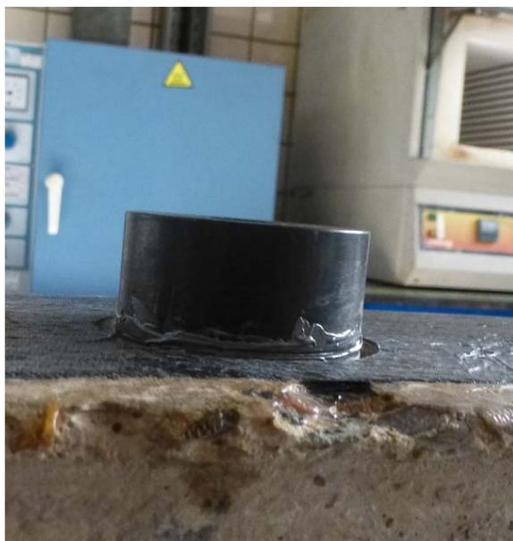
Fig. II.2.11. Pegado del disco con el adhesivo (*Elaboración propia*).
