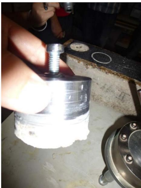
Fig. II.2.14. *Rotura del hormigón I (Elaboración propia).*
