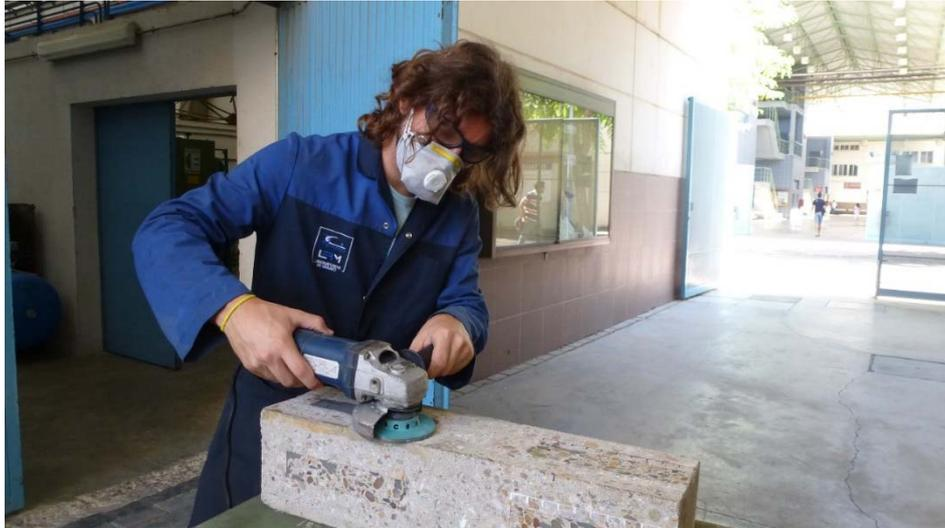
Fig. II.1.21. *Desbastado del hormigón con una amoladora (Elaboración propia).*
