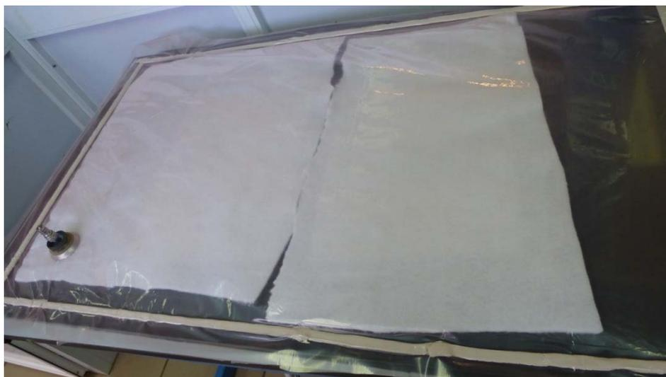
Fig. II.1.7. *Bolsa de vacío intermedia previo a la compactación (Elaboración propia).*
