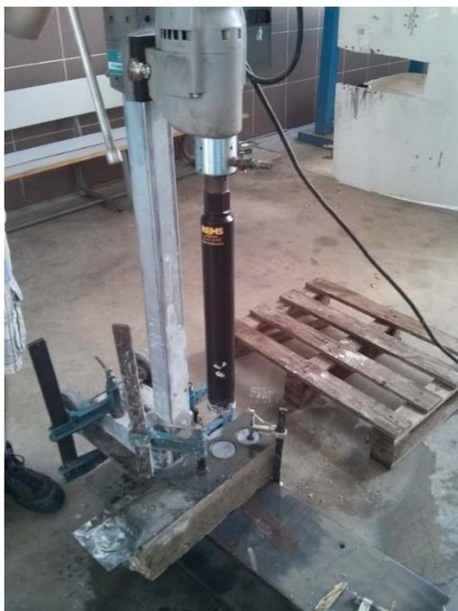
Fig. II.2.5. *Perforadora de hormigón (Elaboración propia).*
