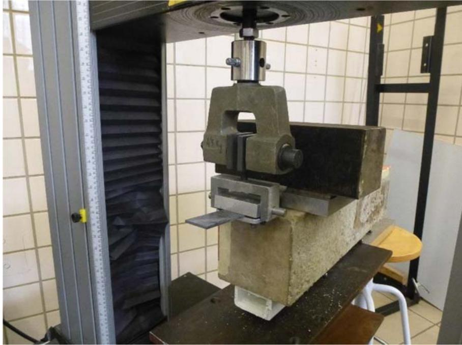
Fig. II.1.34. Carga en el borde con el hormigón (Elaboración propia).
