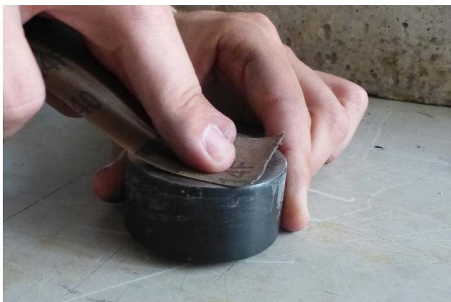
Fig. II.2.9. *Lijado del disco de acero (Elaboración Propia).*
