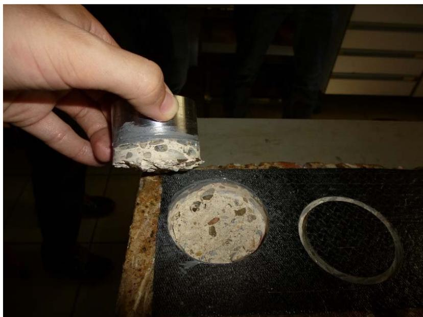
Fig. II.2.15. *Rotura del hormigón II (Elaboración propia).*
