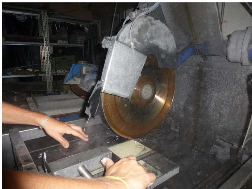
Fig. II.1.17. *Corte del laminado de CFRP con la sierra de disco de diamante
