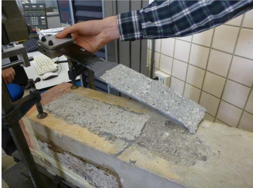
Fig. II.1.33. *Rotura por el hormigón (Elaboración propia).*
