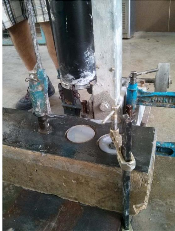
Fig. II.2.6. *Trepanado del bloque de hormigón (Elaboración propia).*
