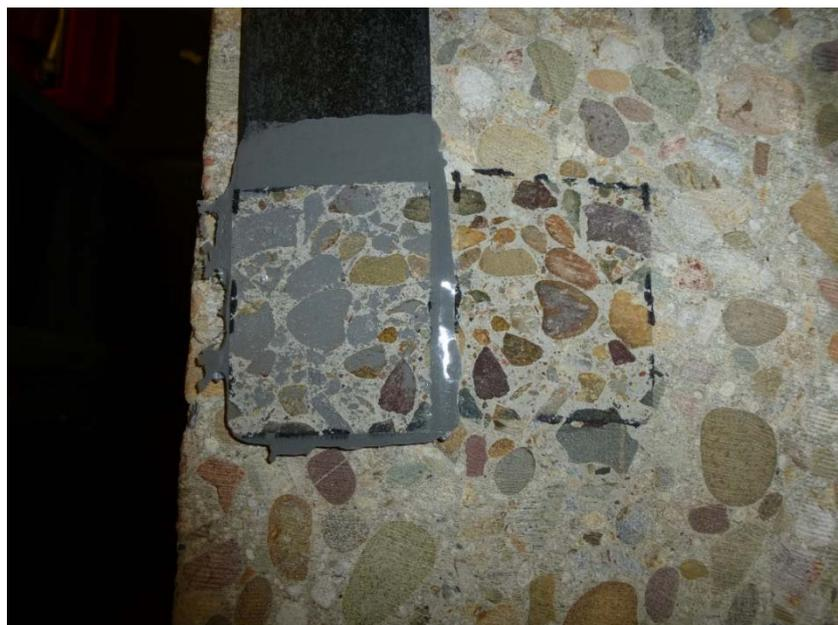
Fig. II.1.50. Vista de la rotura del ensayo LP-50 G I (Elaboración propia).
