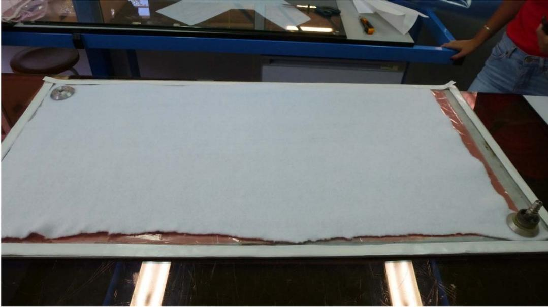
Fig. II.1.13. *Colocación del cromato en los bordes exteriores de la plancha (Elaboración propia).*
