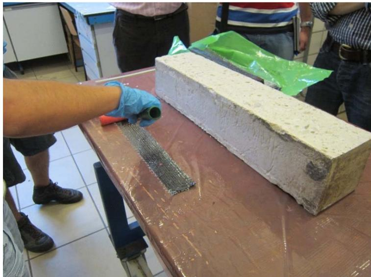
Fig. II.2.2. Aplicación de la resina a la fibra fuera del bloque de hormigón (Elaboración propia).
