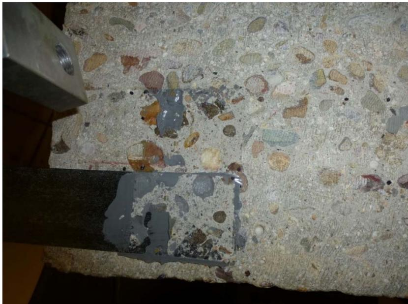
Fig. II.1.44. *Vista de la rotura para el ensayo LP-50 I (Elaboración propia).*
