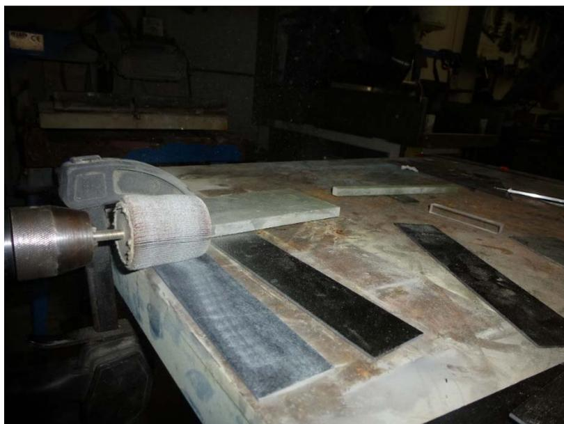
Fig. II.1.19. *Lijado del laminado de CFRP (Elaboración propia).*
