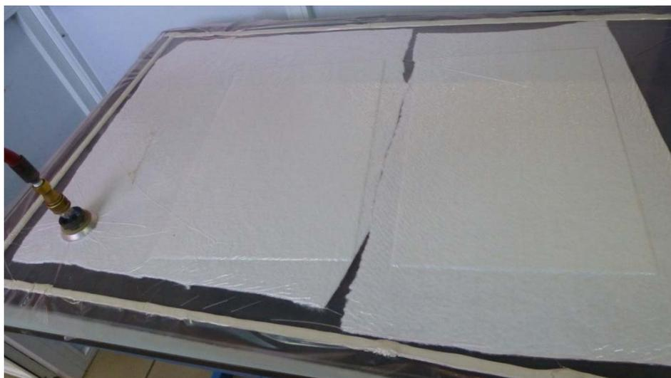
Fig. II.1.8. *Bolsa de vacío intermedia compactada (Elaboración propia).*
