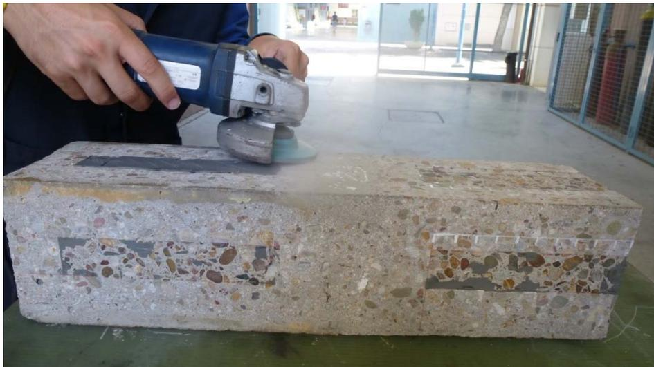
Fig. II.1.22. *Desbastado del hormigón con una amoladora II (Elaboración propia).*
