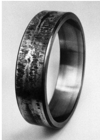
Figura 30. Avería por adherencia.
