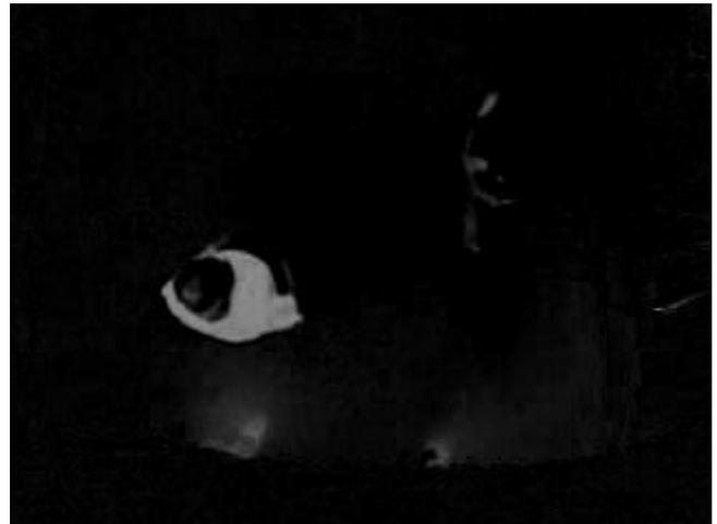
**Figura 3-15.** Resultado de restar la imagen actual al fondo generado en el canal *Value*.
