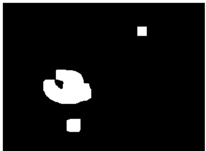
**Figura 3-33.** Resultado de dilatar dos veces la imagen de la figura 3.25.
