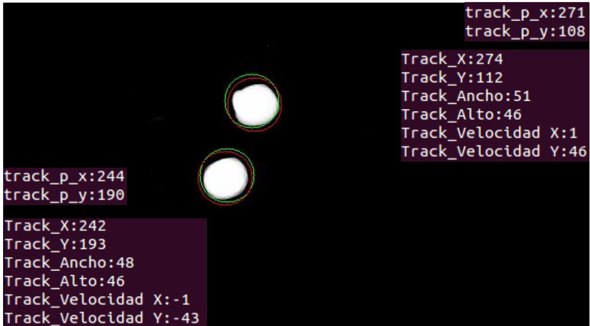
**Figura 4-9.** Imagen previa al cross-tracking, con dos tracks asociados.
