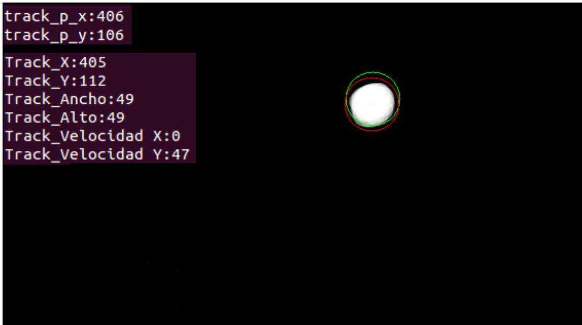
**Figura 4-12.** Imagen previa a un error de segmentación total.
