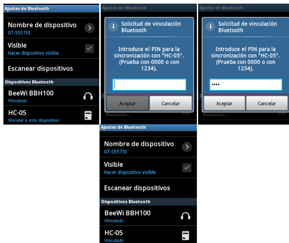
Figura 7-6. Vista previa del emparejamiento desde el dispositivo móvil con el receptor Bluetooth.
