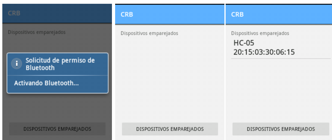
Figura 7-17. Mensaje mostrado al aceptar la petición del servicio Bluetooth y siguientes pantallas.
