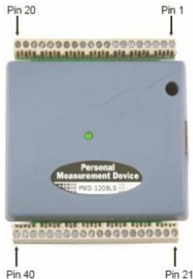
Las características de esta tarjeta son las siguientes: ocho entradas análogas, dos salidas análogas de 10 bits de resolución, 16 conexiones digitales de Entrada/Salida y un contador de eventos externo de 32 bits.
