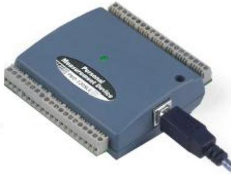
Esta tarjeta se caracteriza por tener dos bancos de borneras, cada uno con 20 conexiones. Cada terminal tiene asociado un número de pin tal y como se indica en la siguiente figura:
