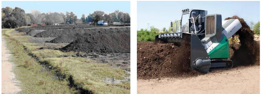
Ilustración 10. Compostaje en hilera y volteadora.
