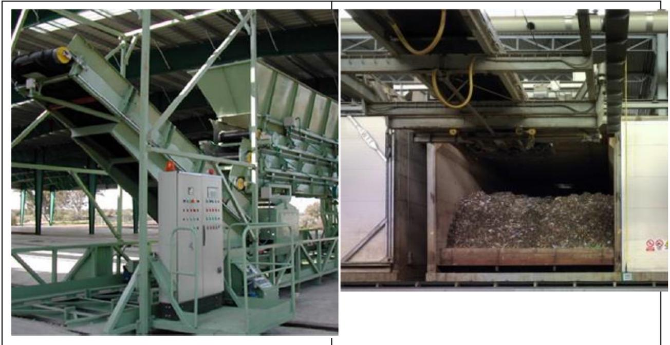
Ilustración 22. Carga automática de los túneles (18)
