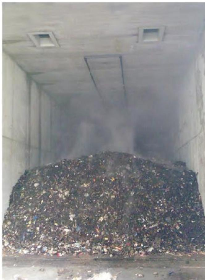
microorganismos aeróbicos, se desarrolla, en este proyecto, dentro de **túneles cerrados**, lo que consigue una degradación más rápida y completa, con un impacto mínimo en el entorno y un mayor control de las variables que intervienen en el proceso
