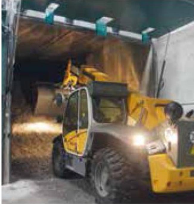
Ilustración 21. Carga de un túnel con pala cargadora
