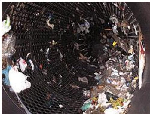
Ilustración 19. Interior del trómel.
