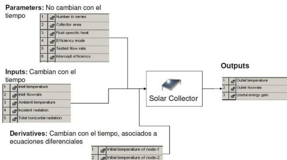
Figura 27. Componente “Solar Collector” (TYPE 1) en TRNSYS.
