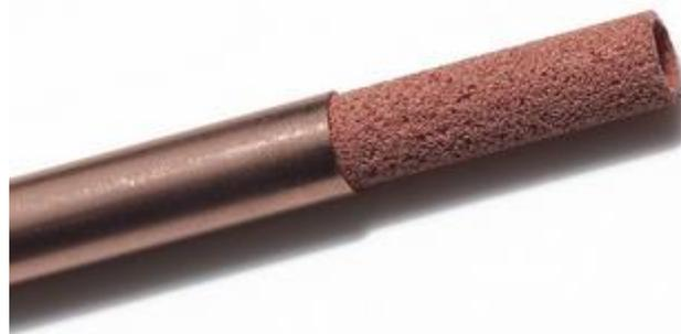
Figura 1–13. Mecha de cobre
