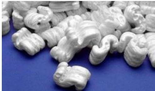
Figura 2–27. Espuma de poliestireno expandido con forma de S
