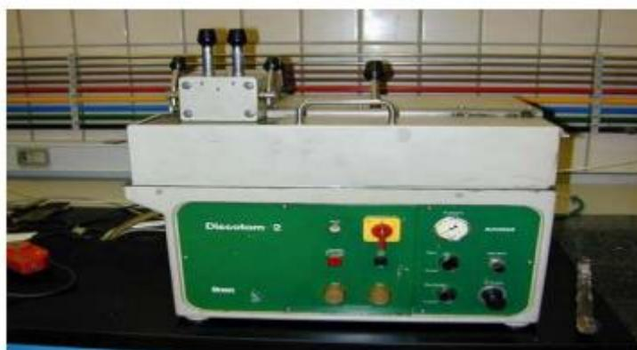
Figura 2-2. Máquina cortadora
