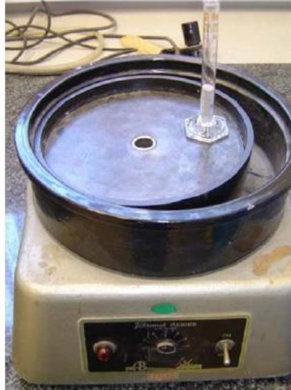
Figura 2-7. Máquina pulidora vibratoria
