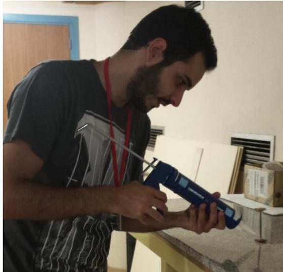
Figura 2–5. Sellado de las probetas
