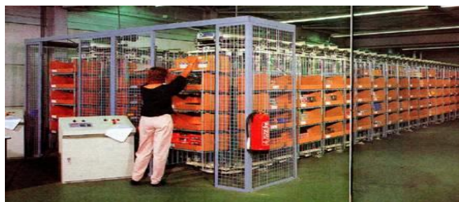
Figura 15c: Almacén tipo carrusel. Fuente: www.monografias.com
