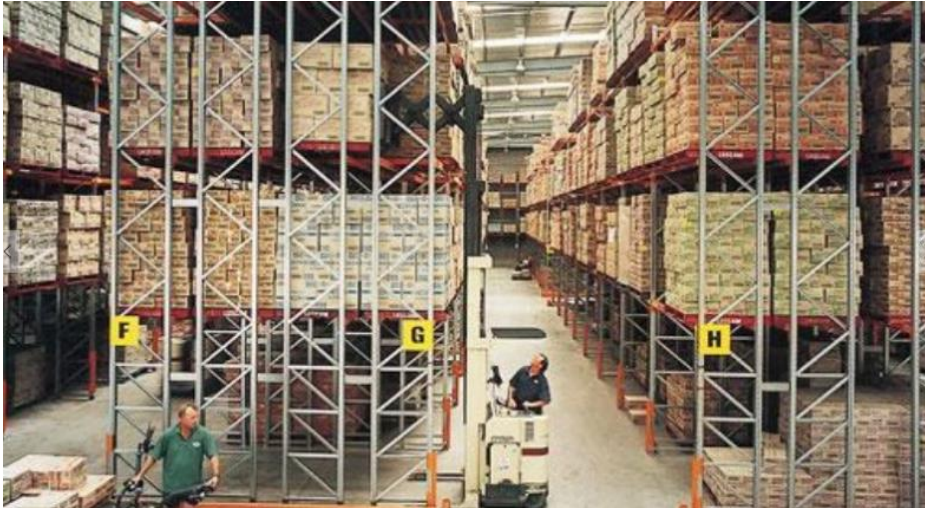
Figura 9: Almacén con estanterías de doble profundidad. Fuente: (Muñuzuri, 2016)
